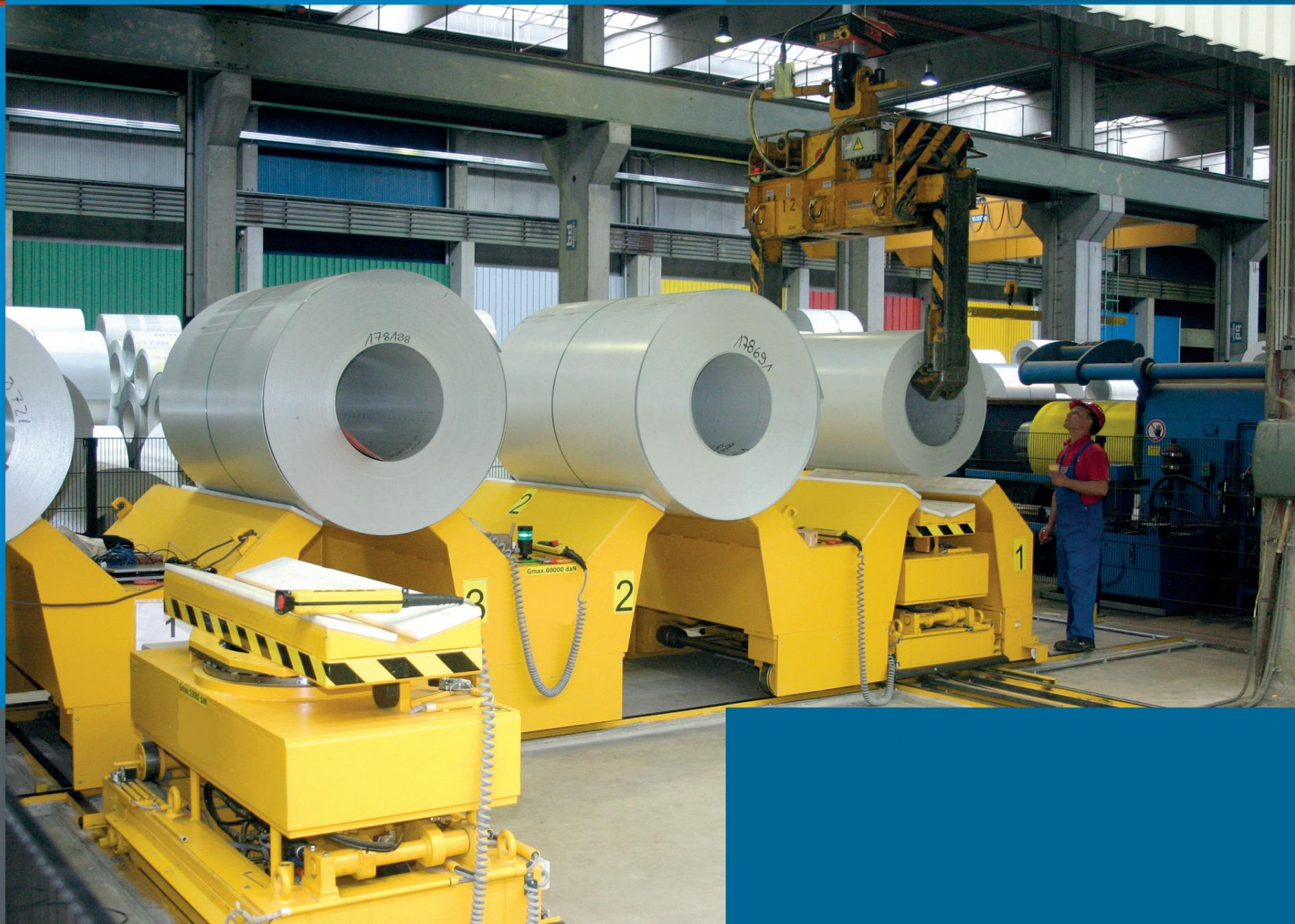
Kraftübertragung im Hydrauliksystem: die Zylinder zwischen den Scheren drücken die Scheren auseinander und heben somit die Plattform an.
